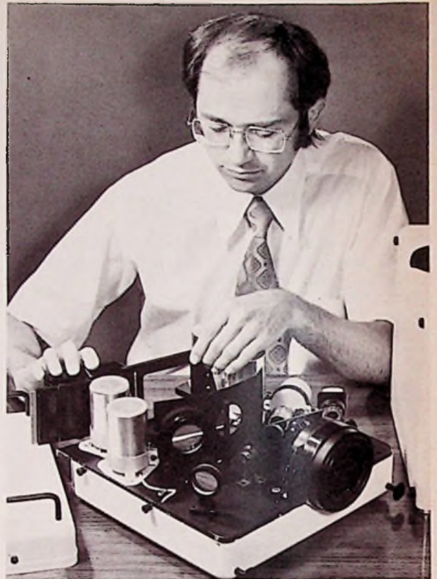
Deze foto toont duidelijk de kleine afmetingen van Hughes' holocamera.
